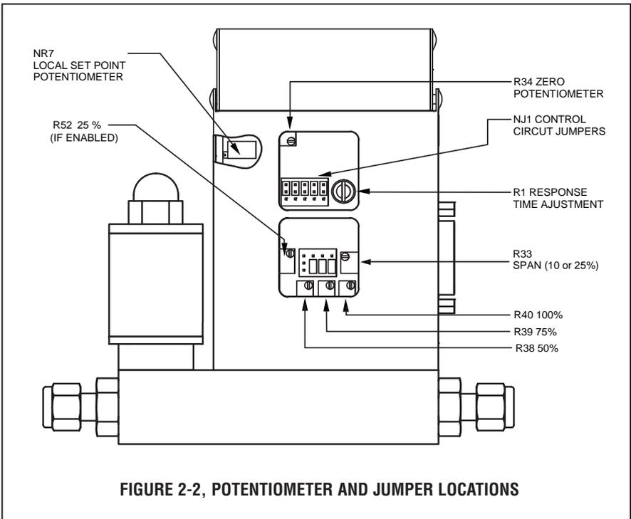
**FIGURE 2-2, POTENTIOMETER AND JUMPER LOCATIONS**
